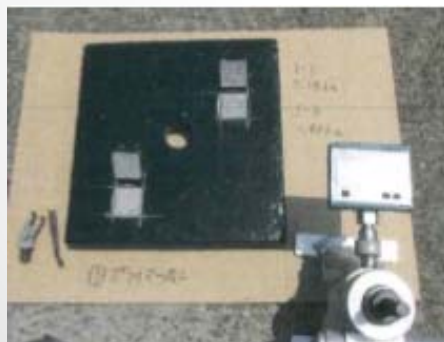
沒有底漆的拉力測試範例 平均1.28N /mm 2 破壞易碎的混凝土表面
